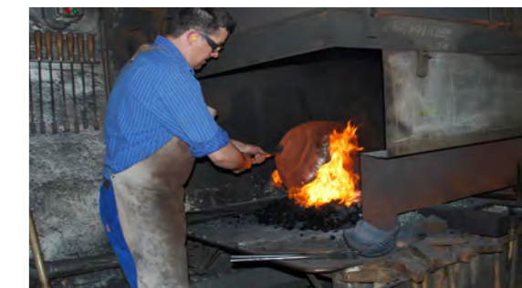
Das Stahlblech erreicht 1000 bis 1200°C
