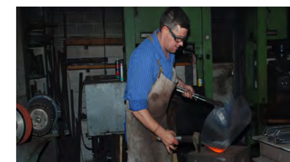
Stahlblech ist schmiedbar bis 800°C
